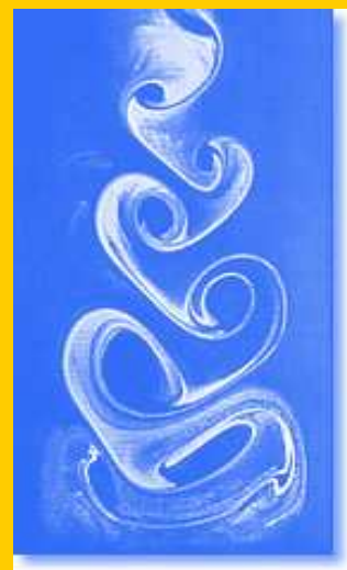
Chaîne tourbillonnaire. Spirales qui se forment en rythme dans un fluide. (d'après Schwenk)
